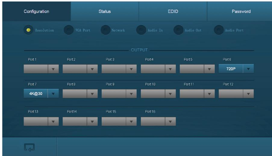
FIGURE 7-9. CONFIGURE OUTPUT RESOLUTION MENU
